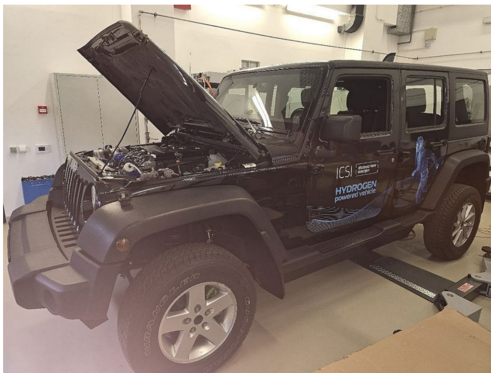
Foto 1. Demonstratorul FCHEV HyDeMo integrat pe platforma Jeep, cu acces la subsistemele energetice.
