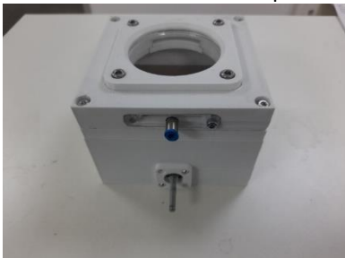
Figura 1: Vedere laterală a camerei de izolare completă, arătând mecanismul pârghiei pentru ridicarea platformei de probă, orificiul de intrare pentru fluxul de înveliș de protecție sub fereastră și fereastra optică fixă cu lărgirea interioară a canalului învelișului pentru asigurarea fluxului laminar orizontal.
