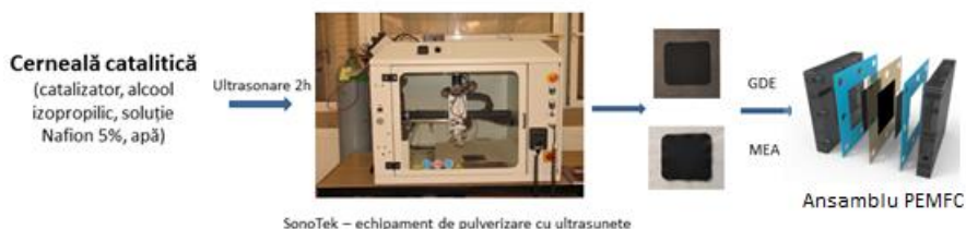
Figura 3. Linie de fabricare ansambluri MEA (ICSI Rm Valcea)
